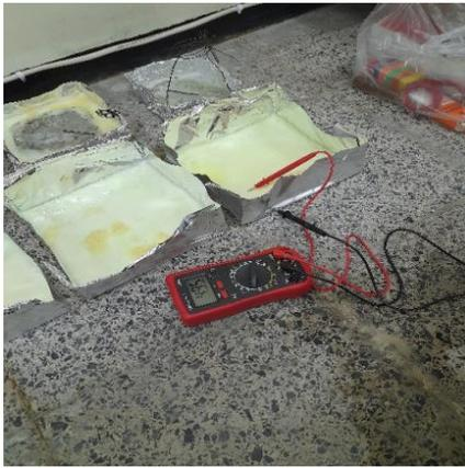
Gambar 8(b) Pengukuran Voltase Kondisi Kering yang melalui proses pengovenan pada putih telur.
