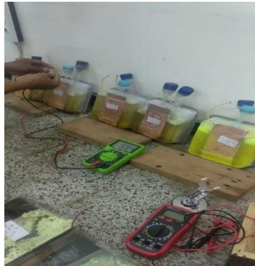
Gambar 9 Pengukuran Voltase Kondisi Basah tanpa melalui proses pengovenan pada putih telur.
