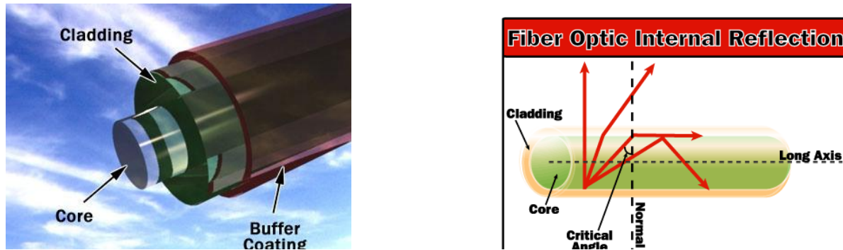
Gambar 28. Kabel Serat Optik dan Proses Pemantulan Cahaya di Dalamnya
